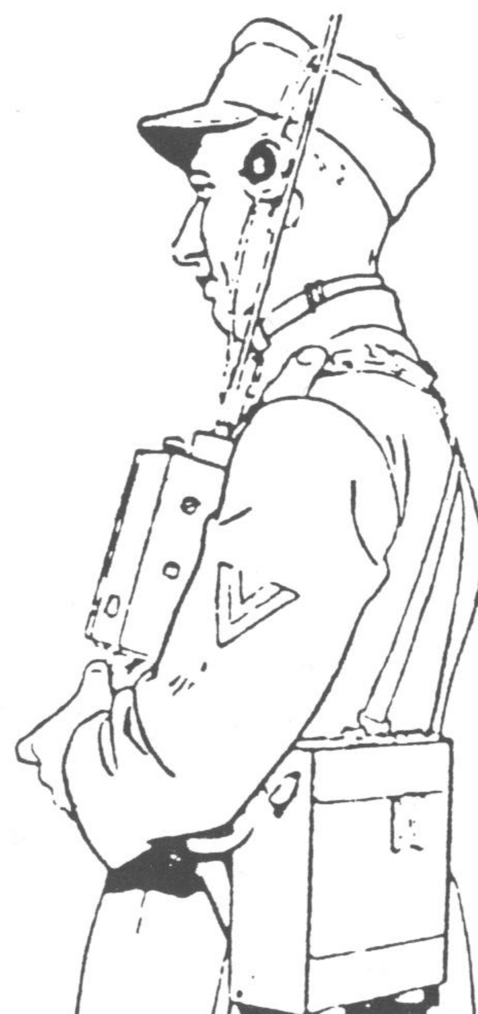
Kl.Fu.Spr.d. – the smallest German transceiver set.
